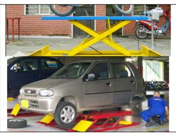
Sistema elevación para vehículos, tipo elevador o plataforma, electro-hidráulico, altamente confiable, bajo consumo de energía, 110/220 voltios. Fácil instalación, no requiere obra civil, adecuado para locales comerciales, oficinas, bodegas.
