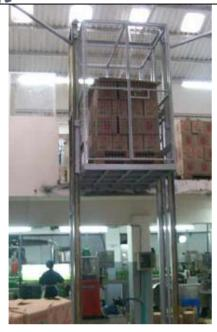
Sistema elevación para carga, tipo elevador o plataforma, electro-hidráulico, altamente confiable, bajo consumo de energía, 110/220 voltios. Fácil instalación, no requiere obra civil, adecuado para hogares, locales comerciales, oficinas, bodegas.
